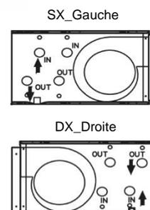
Les flèches indiquent l'entrée et la sortie de la batterie principale.
